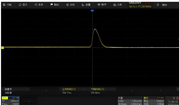
输出信号波形，示波器输入阻抗1MΩ
