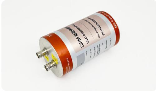
ENAI-D50H50SIPM01 是一款专为精密能谱分析设计的高度集成化探测器。它将 2 英寸碘化钠(NaI(Tl))闪烁晶体、16 片 ONSEMI C60035、求和电路、前置放大电路等核心部件进行一体化封装与优化，构成了一个紧凑、高性能的探测单元。该探测器凭借其卓越的能量分辨率、极高的可靠性和简化的集成流程，有效降低了用户的系统开发难度与成本。是工业过程控制、放射性医疗诊断及环境辐射监测等应用的理想选择，为各类辐射探测与分析系统提供稳定、精准的核心探测能力。
