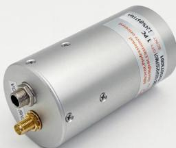
ELBC-D25H25SIPM01 是一款高性能标准型能谱探测器，它创新性地融合了 1 英寸溴化镧 ( $\text{LaBr}_3$ ) 闪烁晶体与 SiPM ( 硅光电倍增器 ) 技术。其核心优势在于采用了 16 片 ONSEMI J60035 SiPM 构成的阵列式光电探测方案，并集成了高效的信号求和与前置放大电路。这一设计确保了对伽马射线的高效收集与快速处理。得益于此，该探测器在实现高能量分辨率与高计数率的同时，凭借其高度集成化的设计，显著减小了体积并保障了长期稳定性。凭借其卓越性能、紧凑设计及高性价比，ELBC-D25H25SIPM01 成为各类辐射测量应用中值得信赖的前端探测单元。
