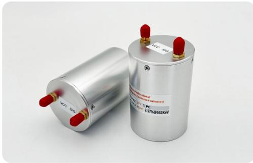
ELBC-D38H38SE增强型能谱探测器：集高性能与紧凑设计于一身。它内置1.5英寸高分辨率低余晖溴化镧闪烁晶体、32片ONSEMI J60035 SiPM阵列，以及求和、前置放大电路，实现了高度集成。凭借其卓越的能量分辨率、简单直观的操作、小巧的身材和可靠的性能，这款探测器正广泛应用于工业探测、放射医疗和辐射监测，为各领域提供精准可靠的解决方案。
