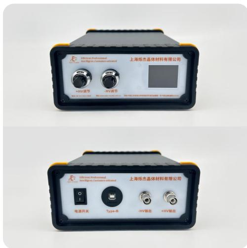
双极性可调高压电源 EHVDC01 为一款高精度的 DC-DC 高压电源，能够提供正负两种极性的高压。使用 TYPE-B 接口 USB 供电，正负高压输出范围均为 0-1500V 且可以分别设置不同极性高压同时输出，支持通过前面板旋钮线性可调的连续调节输出电压，并通过显示屏实时显示输出电压的大小及极性。该模块输出电压稳定，工作与储存温度范围宽广，低 EMI、抗干扰能力强，适用于各类环境，便于客户快速、便捷地获取所需高压，满足测试需求。
